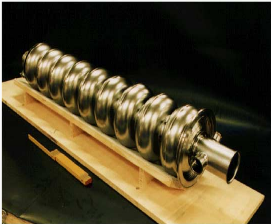
Fig. 5.2.3.1-2. TTF 9-cell 1300 MHz cavity (TESLA 2001)
