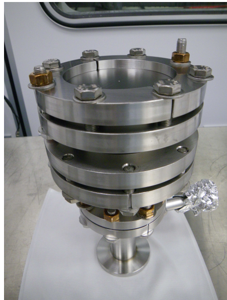
(d) The fully assembled TE pillbox cavity.
